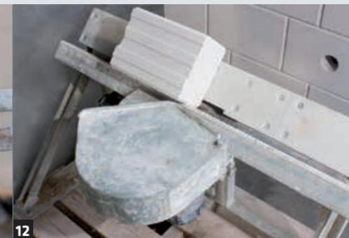
12 Bei größeren Mengen werden gesägte Passsteine mit der Fasenmaschine angefast.
