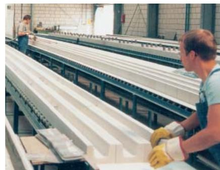
Bild 11: Ausrichten der KS-Sturzschalen.
