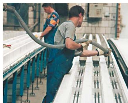
Bild 12: Verfüllen der KS-Sturzschalen.
