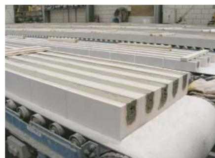
Bild 13: KS-Flachstürze nach dem Verfüllen.
