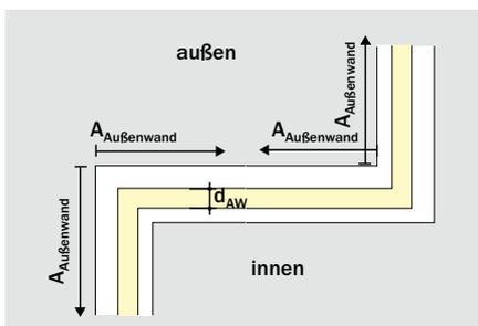
**Bild 3 und Tafel 2: Horizontaler Außenmaßbezug (im Grundriss) bei Außen- und Innenecke bei Außenwänden mit Vormauerschale und Kerndämmung (gilt auch für Kerndämmung mit Fingerspalt).** Durch den Außenmaßbezug können sich bei der Außenecke (links) negative  $\Psi$ -Werte ergeben; bei der Innenecke (rechts) sind die  $\Psi$ -Werte immer positiv.
