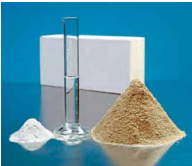
Bild 1 Die Rohstoffe: Kalk, Sand und Wasser
