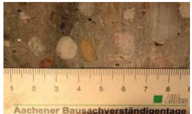
Bild 31 Heute üblicher Konstruktionsbeton weist bei Verarbeitung mit üblicher Sorgfalt eine dichte Struktur auf, die das WU-Beton-Kriterium erfüllt
