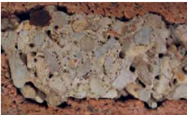
Bild 30 Früherer Beton hatte üblicherweise eine stark poröse Struktur und wies einen (sehr) geringen Feuchteschutz auf
