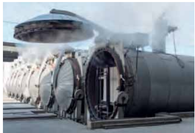
Bild 5 Das Härten der Rohlinge erfolgt in Dampf-Härtekesseln
