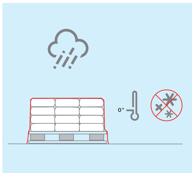
Bild 1 Lagern von Stein und Mörtel
