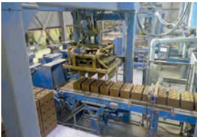
Bild 4 Nach dem Mischen werden die Rohlinge gepresst
